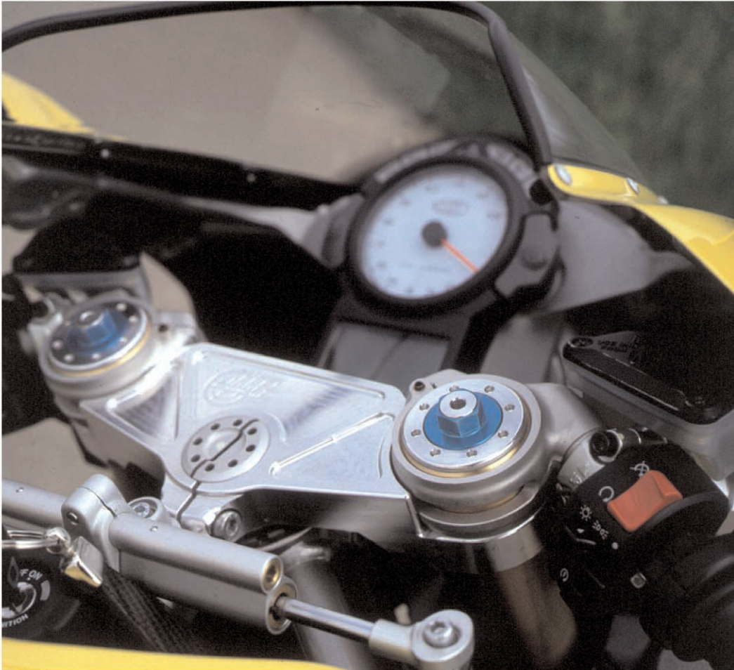
Komfort-Tuning, das auch dem Auge gefällt. Die Lenkerstummel werden über der März-Gabelbrücke montiert
